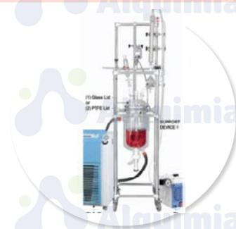
**Conjunto de reactor calentado por manto LaboRactor™ de 2 a 50 litros, con (1) “hervidor” de recipiente de vidrio de pared simple o (2) matraces redondos**
